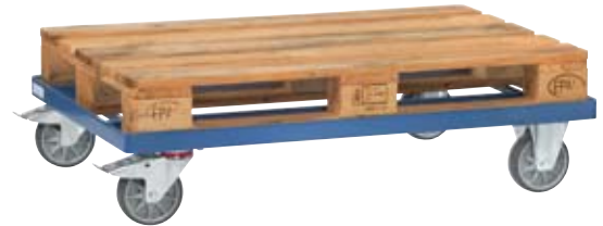
1 • Ohne Fangecken • TPE-Bereifung, Rad-Ø 160 mm, Naben mit Rillenkugellager • Ladehöhe 216 mm
