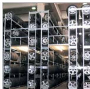
Zweigeschoss-Regalanlage mit Stufenbalken für die Einlagerung von 40.000 Komplettträgern
