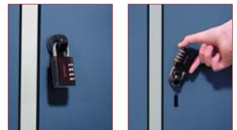
Sicherheits-Drehriegelverschluss für Vorhangschloss (dreht in verschlossenem Zustand durch und verhindert damit das Aufbrechen durch Überdrehen), inkl. Türschutz
