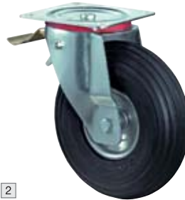
2 Lenkrolle mit Feststeller Stahlfelge und Stollenprofil Rad-Ø 260 mm in schwarz
