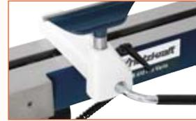
Spindel mit ASR-Abfallsicherung
