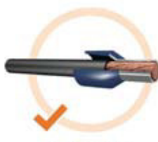
Aus dem Kupferrohr ragende Leiterlitzen
